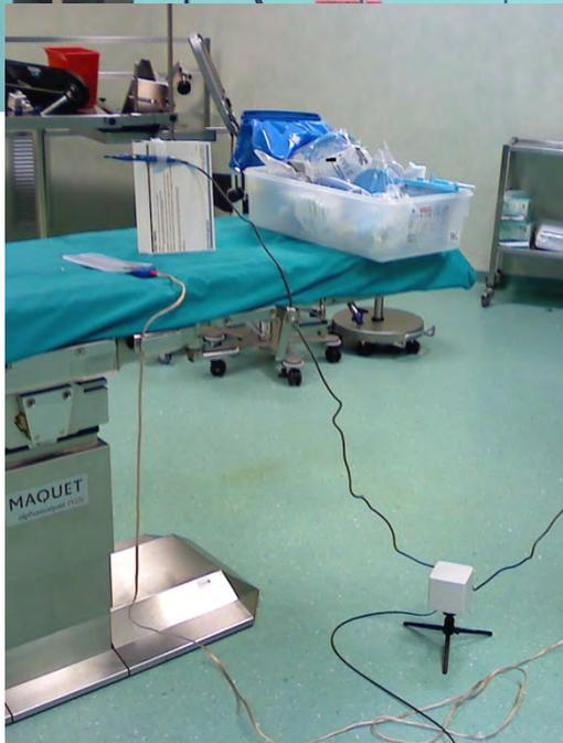
**Elettrobisturi a RF: utilizzano correnti a radiofrequenza (350 KHz – 3.0 MHz) con emissione sinusoidale continua o modulata e/o pulsata. Le potenze erogate arrivano fino a 400 watt. Ad oggi non esiste uno standard per l'esecuzione di misure attendibili per la valutazione dei livelli di esposizione.**
