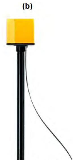
Catene strumentali per la misura dei CMG: (a) sonda Narda ELT-400 con sistema di acquisizione; (b) sonda Narda-PMM EHP-50F.
